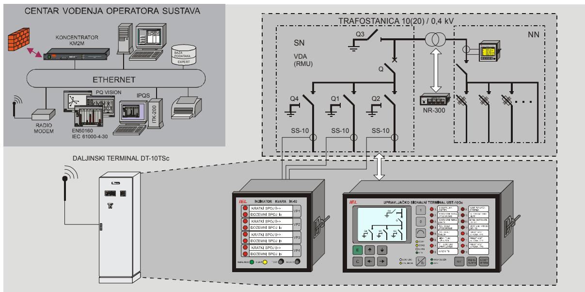
slika 1. Daljinski terminal DT-10TSc u ormaru za trafostanicu 10(20)/0,4kV sa kompaktnom aparaturom
