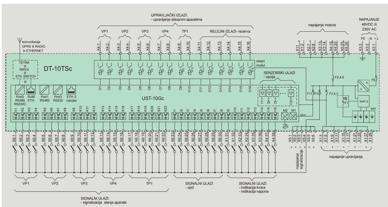
slika 2. Plan priključaka Daljinskog terminala DT-10TSc za 4VT sklopnu aparatu
